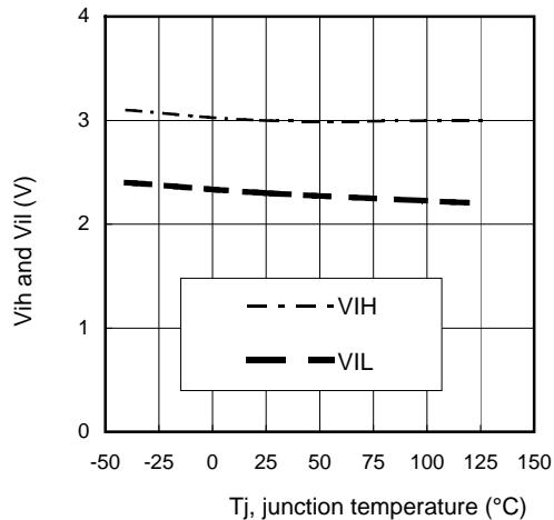
Figure 6 –  $V_{ih}$  and  $V_{il}$  (V) Vs  $T_j$  (°C)
