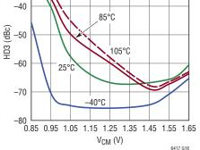
HD3 at 500MHz vs V<sub>CM</sub> Over V<sup>+</sup>
