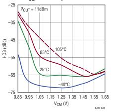
HD3 at 380MHz vs V<sub>CM</sub> Over V<sup>+</sup>
