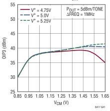
OIP3 at 500MHz vs V<sub>CM</sub> Over V<sup>+</sup>
