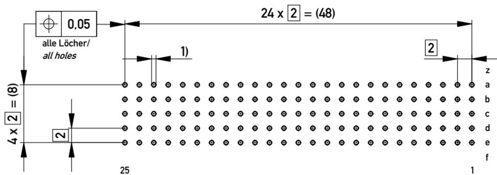
1)  $\varnothing 0,6 \pm 0,05$  Durchmesser des metallisierten Loches
