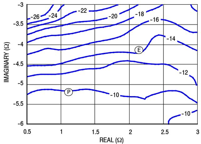
Figure 32. P1dB Load Pull AM/PM Contours (°)
