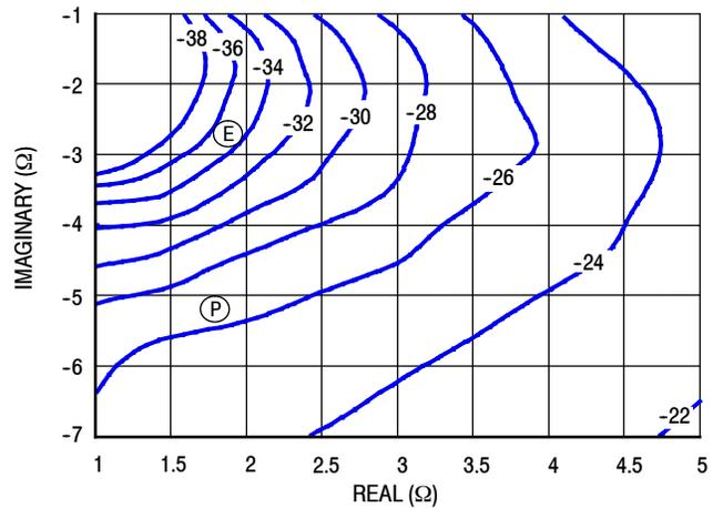
Figure 40. P1dB Load Pull AM/PM Contours (°)
