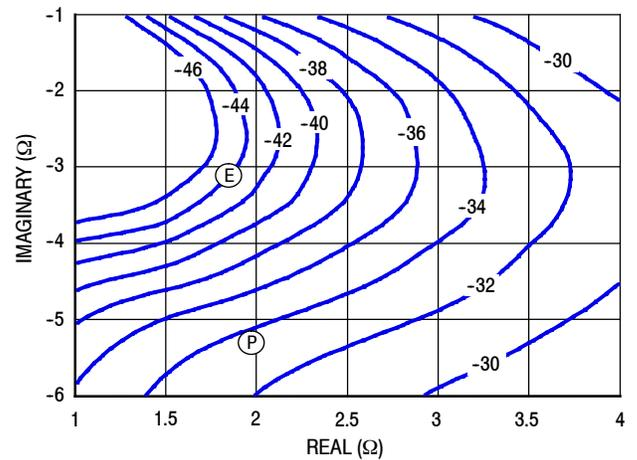
Figure 44. P3dB Load Pull AM/PM Contours (°)
