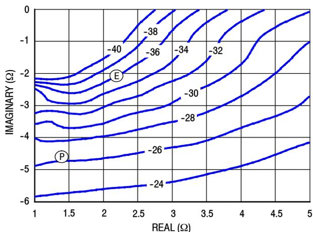
Figure 20. P1dB Load Pull AM/PM Contours (°)
