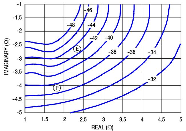
Figure 24. P3dB Load Pull AM/PM Contours (°)
