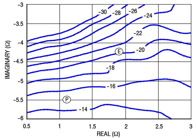
Figure 36. P3dB Load Pull AM/PM Contours (°)
