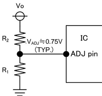
$$V_O \doteq V_{ADJ} \times (R_1 + R_2) / R_1$$
