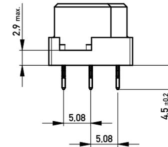
Elastische Einpresszone / *compliant pressfit zone*
