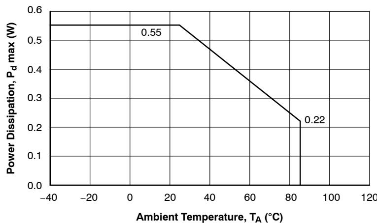
**Figure 3. P<sub>d</sub> max-T<sub>A</sub> Graph**
