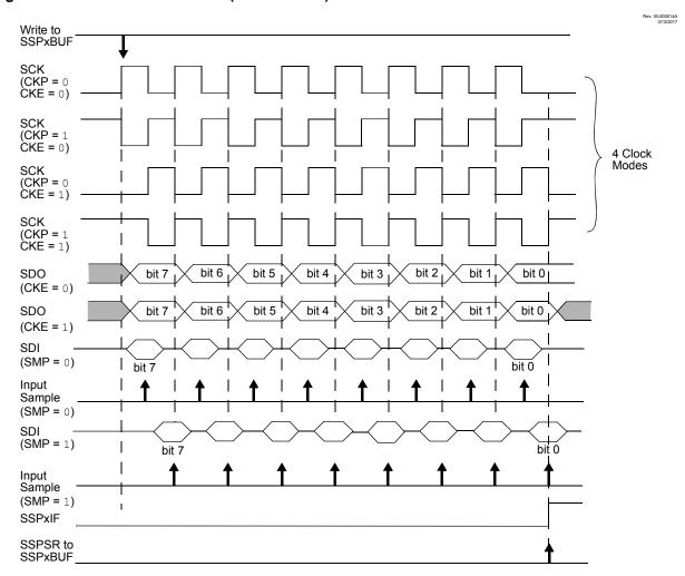
Figure 26-4. SPI Mode Waveform (Master Mode)
