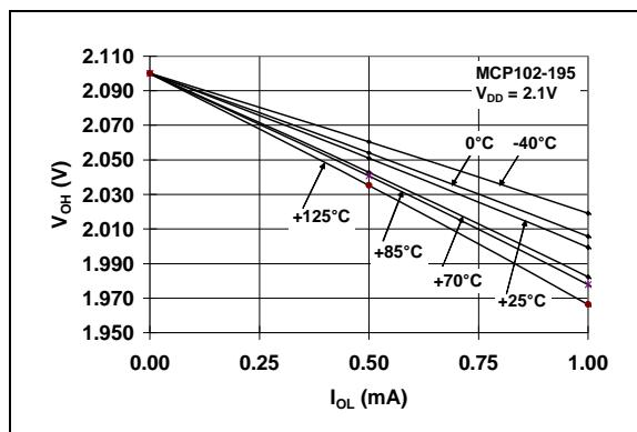
**FIGURE 2-22:**  $V_{OH}$  vs.  $I_{OL}$
