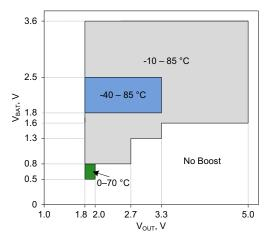
Figure 11-10.  $L_{\mbox{\footnotesize{BOOST}}}$  values over  $V_{\mbox{\footnotesize{BAT}}}$  and  $V_{\mbox{\footnotesize{OUT}}}$
