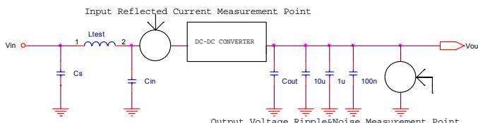
$$Cs=270\mu F \times 1, Ltest=2\mu H, Cin=270\mu F \times 1$$
