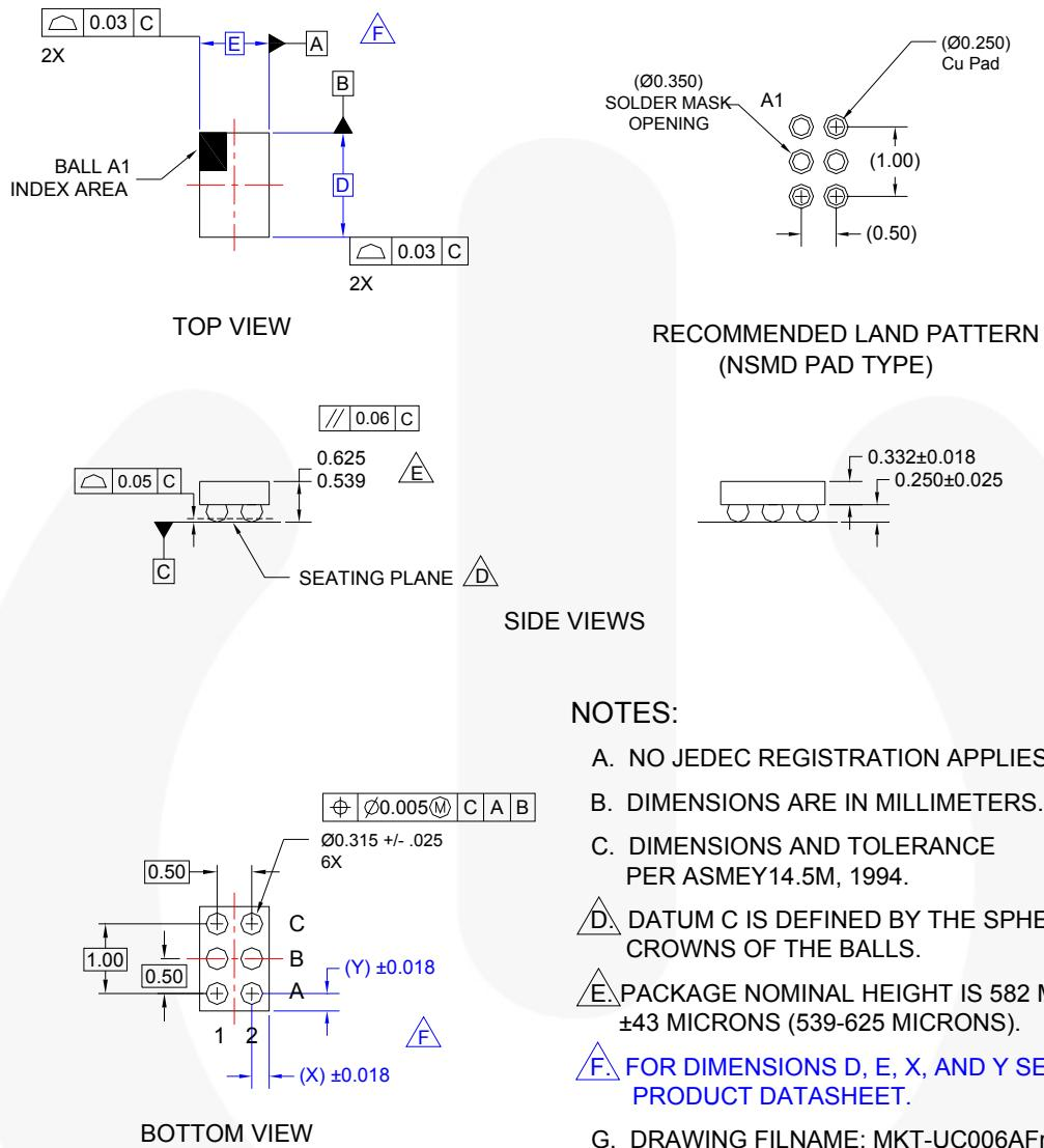
Figure 25. 1.0 x 1.5 mm<sup>2</sup> Wafer-Level Chip-Scale Package (WLCSP)
