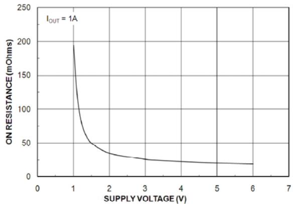
Figure 12. R<sub>ON</sub> vs. V<sub>IN</sub>
