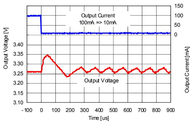
20) Output voltage waveform (Ta=25°C)
