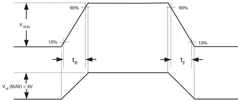
$$\frac{dV_o}{dt} = \frac{(0.8)V_{PEAK}}{t_R} \text{ OR } \frac{(0.8)V_{PEAK}}{t_F}$$
