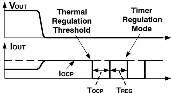
**Figure 24. Short circuit**
