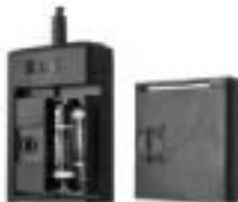
Fig 6: ARRIERE DE L'ACF-3000 SR AVEC COUVERCLE DES PILES ENLEVE
