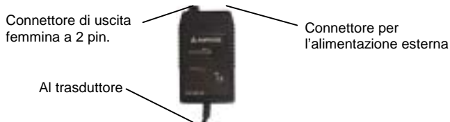
Fig. 1 – ACF-3000 SR ELETTRONICA
