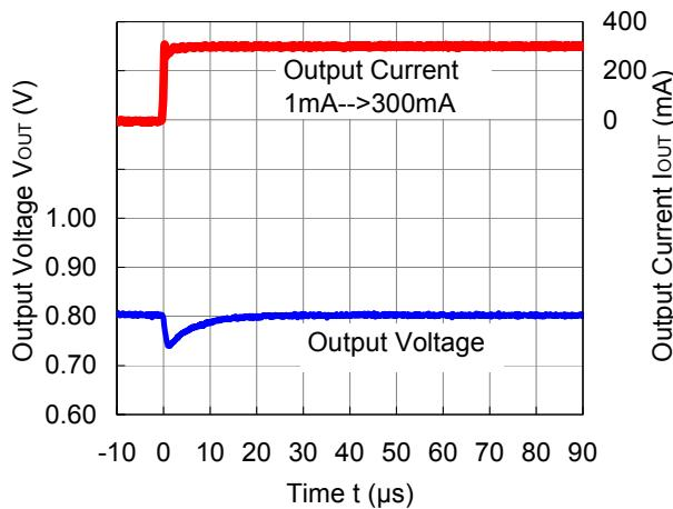
**RP504x081x ( $V_{IN} = 3.6$  V)**
