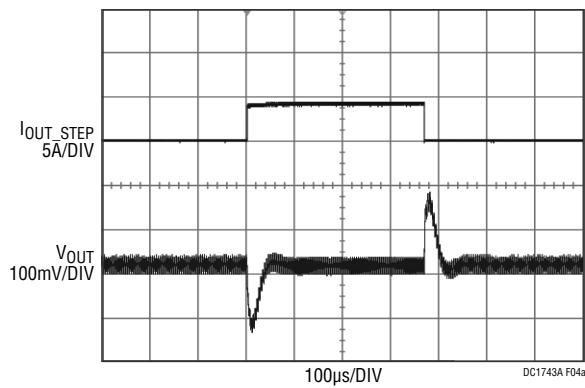
V<sub>IN</sub> = 12V, V<sub>OUT</sub> = 5V
