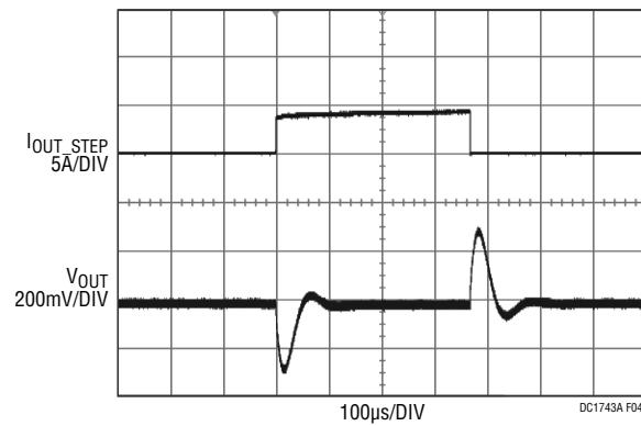
V<sub>IN</sub> = 24V, V<sub>OUT</sub> = 12V
