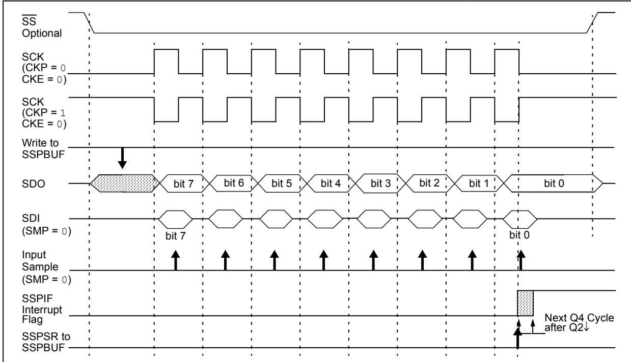
**FIGURE 18-6: SPI MODE WAVEFORM (SLAVE MODE WITH CKE = 1)**
