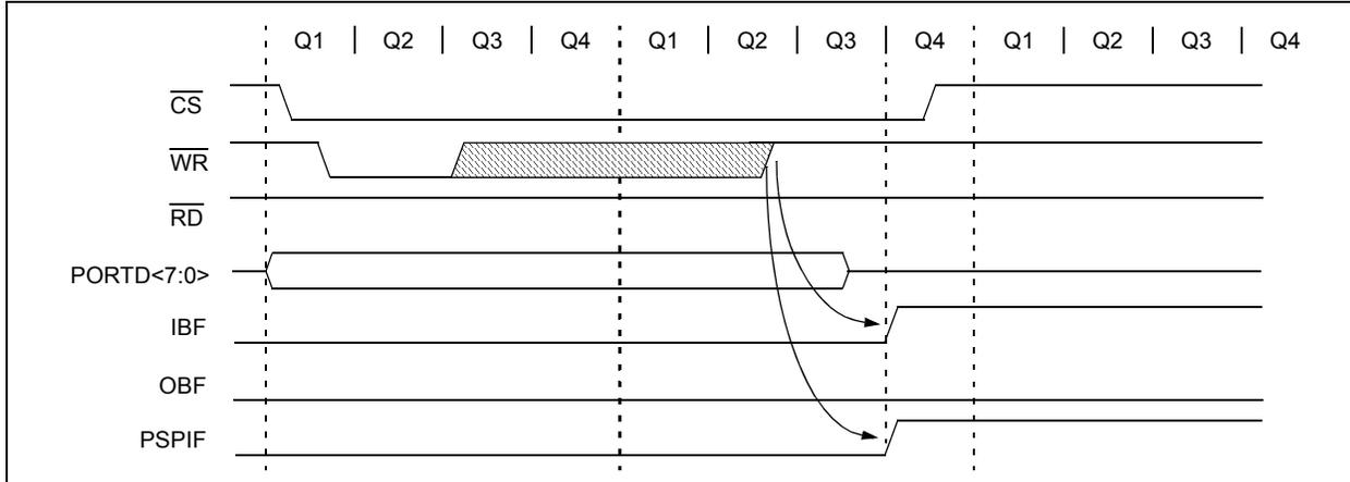
**FIGURE 11-4: PARALLEL SLAVE PORT READ WAVEFORMS**
