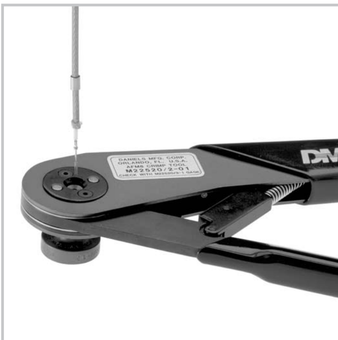
Crimping the inner conductor with hand cimp tool M22520/2-01 . Crimpfung des Innenleiters mit der Handcrimpzange M22520/2-01 .
