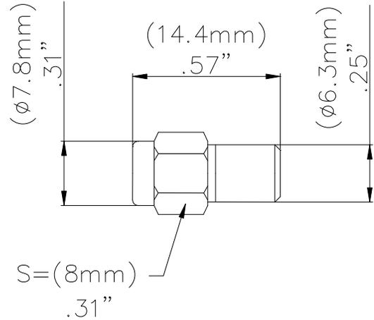
Model 72975 SMA PLUG, 50 OHM TERMINATION
