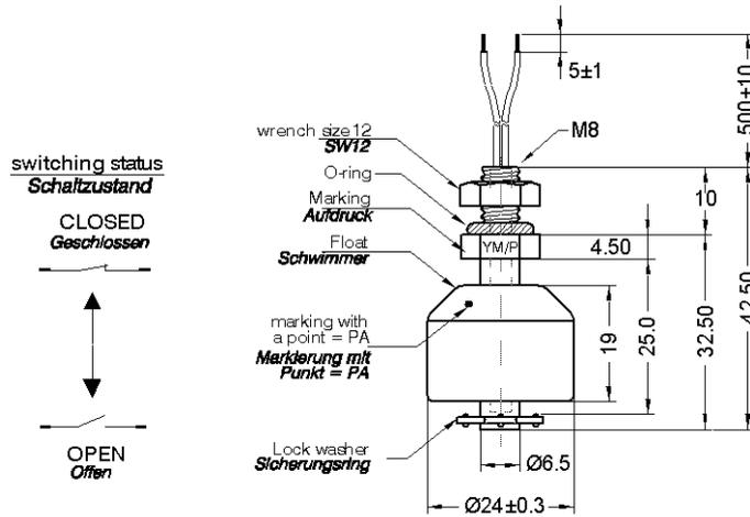
Abmessungen / dimensions (mm)
