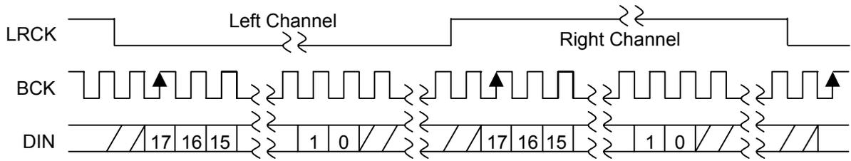
Figure 3.4. 18 bits I<sup>2</sup>S Data Format
