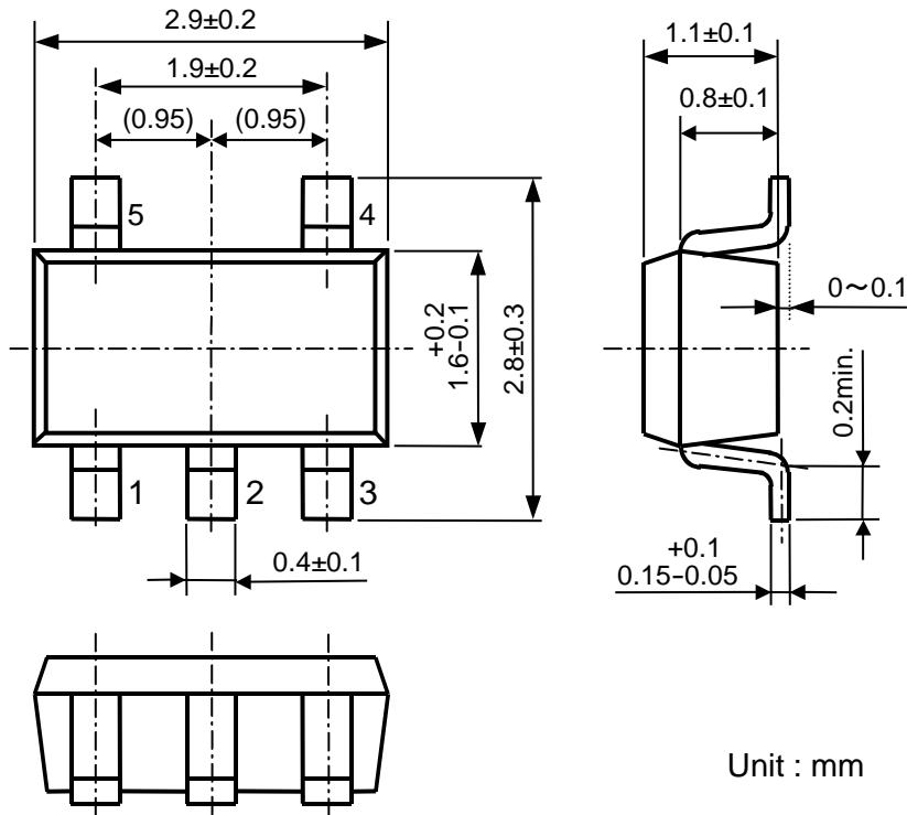
**SOT-23-5 Package Dimensions****MARK SPECIFICATION (SOT-23-5)**
