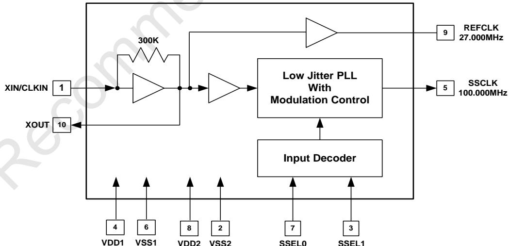
**Figure 1. Block Diagram**
