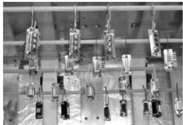
Storage of the test object during the mixed gas exposure Lagerung der Testobjektes während der Mischgasexposition
