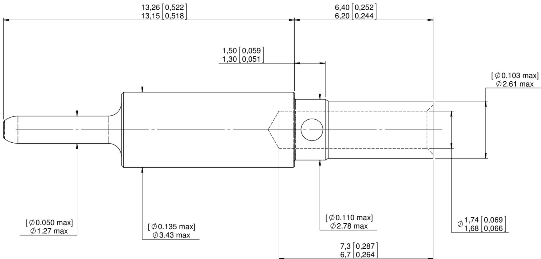
MATERIAL: COPPER ALLOY HARDNESS IN KNOOP 120 MAX (120 HV) FOR CRIMP BARREL
