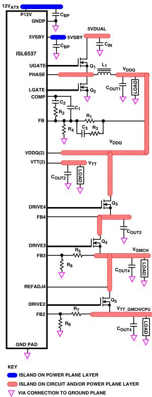
FIGURE 2. PRINTED CIRCUIT BOARD POWER PLANES AND ISLANDS
