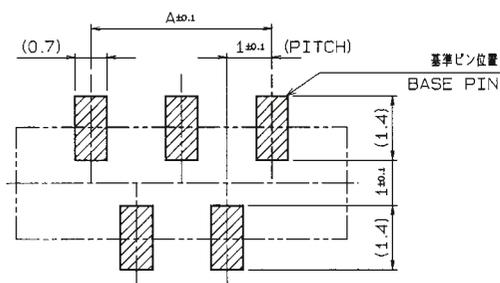
基板取付け寸法 (コネクタ搭載面側)
