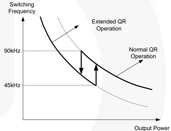
**Figure 30. Extended Quasi-Resonant Operation**
