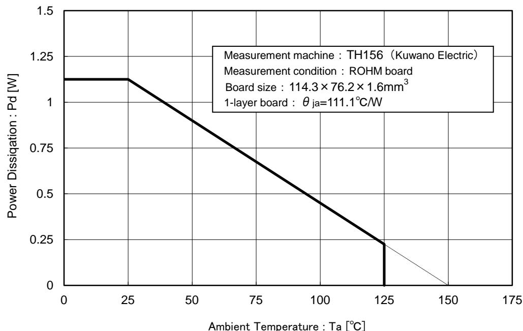
Figure 91. SSOP-B28W Power Dissipation Curve ( $P_d$ - $T_a$  Curve)
