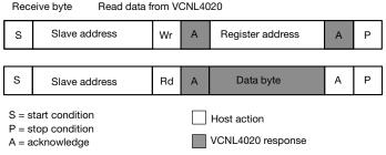
Fig. 11 - Send Byte/Receive Byte Protocol
