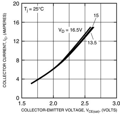
**COLLECTOR-EMITTER SATURATION VOLTAGE CHARACTERISTICS**
