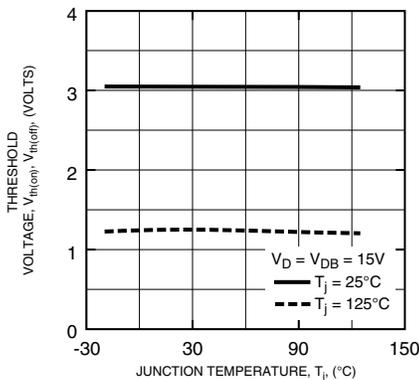
**TRIP LEVEL CONTROL SUPPLY UNDER-VOLTAGE VS. JUNCTION TEMPERATURE (TYPICAL - CONTROL PART N-SIDE)**
