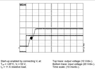
Bottom trace: input voltage (20 V/div.). Time scale: (10 ms/div.).
