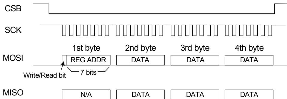
**Figure 7. SPI module frames format - 4 byte access**
