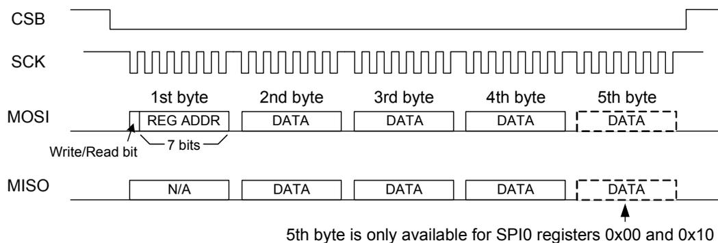
**Figure 8. SPI modules frames format - 5 bytes access**
