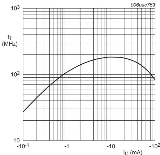
$V_{CE} = -5 \text{ V}$ ;  $T_{\text{amb}} = 25^\circ\text{C}$
