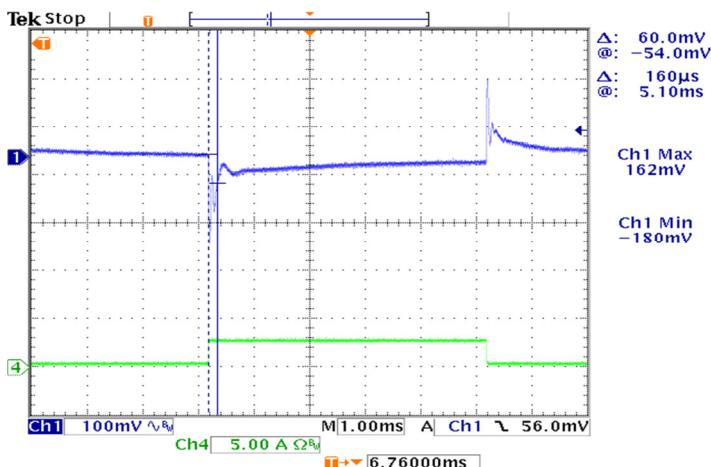
5%~50% Load Transient (AC) at 25°C@115V
