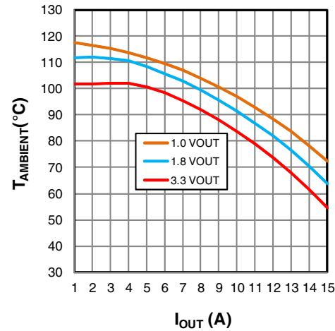
Figure 22: Maximum  $T_{AMBIENT}$  vs  $I_{OUT}$ ,  $V_{IN}=12\text{V}$
