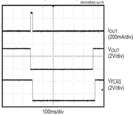
**SWITCH DROPOUT VOLTAGE
