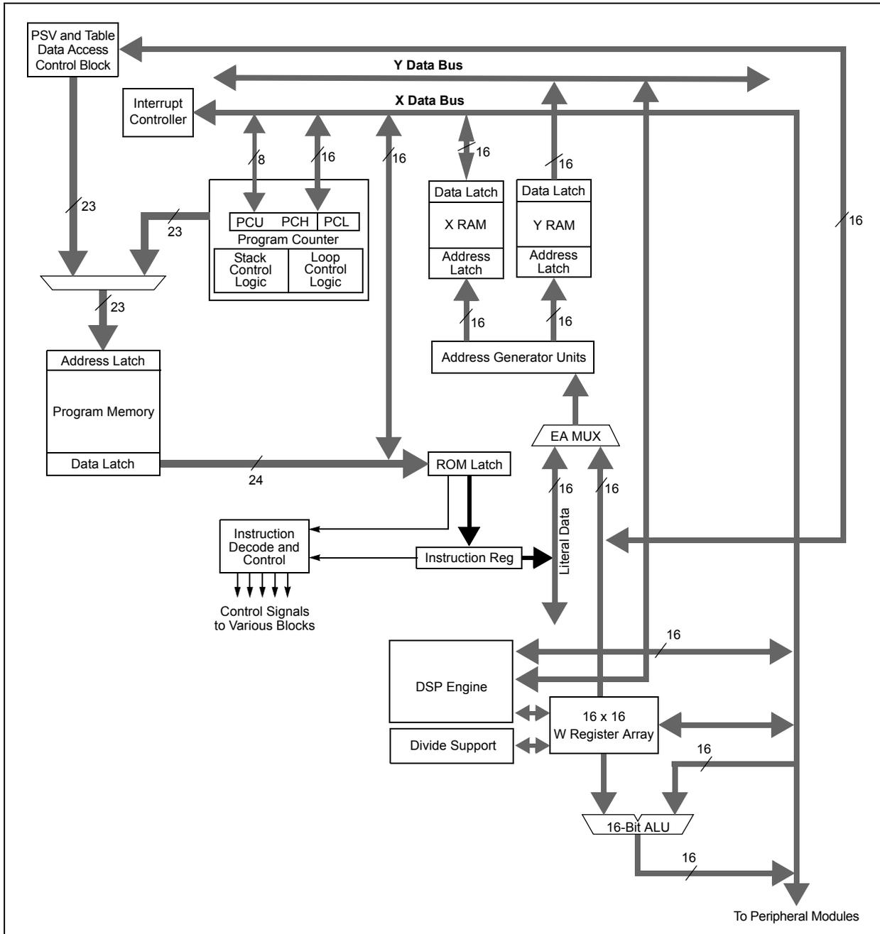
**FIGURE 3-2: dsPIC33FJ16(GP/MC)101/102 AND dsPIC33FJ32(GP/MC)101/102/104 PROGRAMMER'S MODEL**
