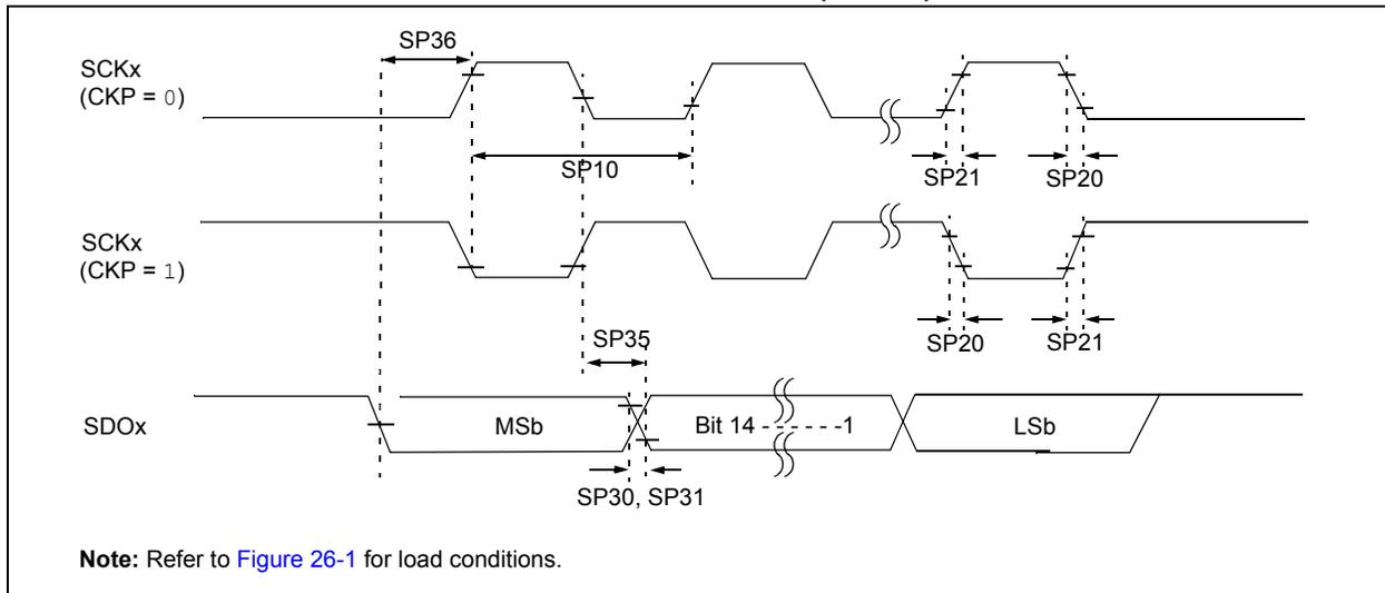
**TABLE 26-30: SPIx MASTER MODE (HALF-DUPLEX, TRANSMIT ONLY) TIMING REQUIREMENTS FOR dsPIC33FJ16(GP/MC)10X**
