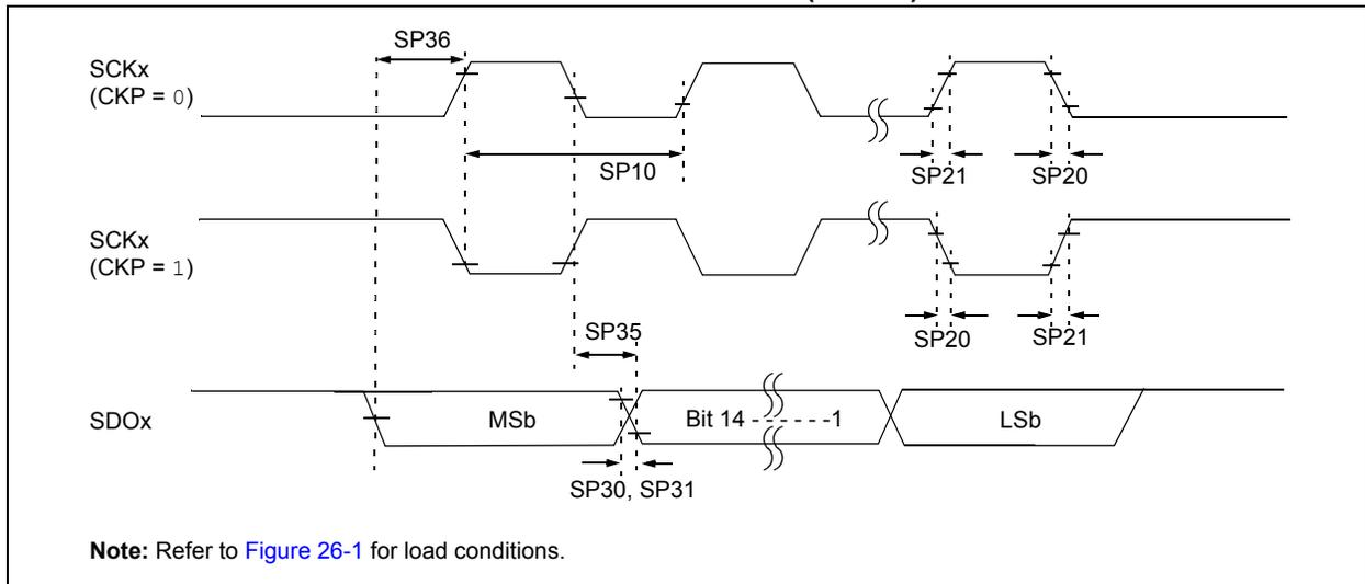
**TABLE 26-38: SPIx MASTER MODE (HALF-DUPLEX, TRANSMIT ONLY) TIMING REQUIREMENTS FOR dsPIC33FJ32(GP/MC)10X**
