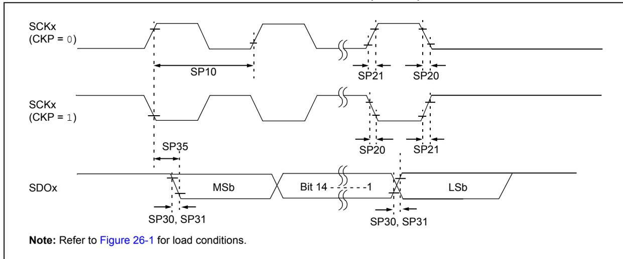
**FIGURE 26-20: SPIx MASTER MODE (HALF-DUPLEX, TRANSMIT ONLY, CKE = 1) TIMING CHARACTERISTICS FOR dsPIC33FJ32(GP/MC)10X**
