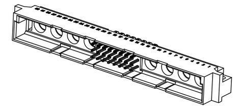
Lötanschluss 0,6x0,6mm / solder terminal 0,6x0,6mm
