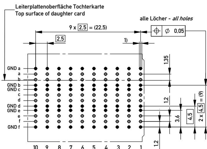
1)  $\varnothing 0.46 \pm 0.05$  Durchmesser des metallisierten Loches
