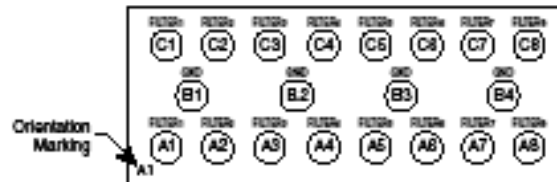
CM1451-08CS/CP 20-Bump CSP Package
