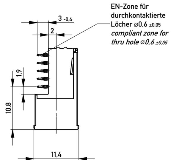
1)  $\varnothing 0.6 \pm 0.05$  Durchmesser des metallisierten Loches
