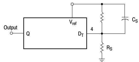
Figure 16. Soft-Start Circuit
