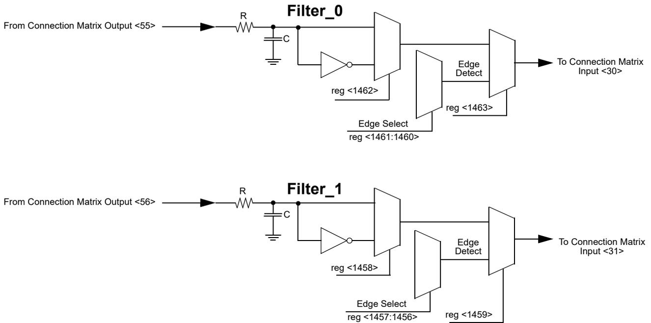
Figure 61. Deglitch Filter / Edge Detector
