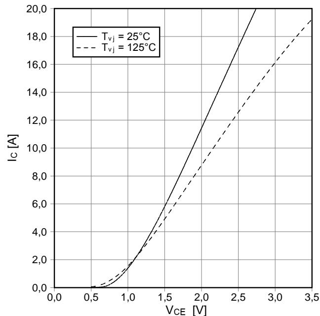
Durchlaßkennlinie der Diode-Brems-Chopper (typisch)
