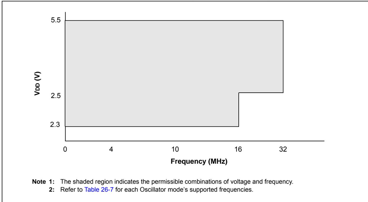
**FIGURE 26-2: VOLTAGE FREQUENCY GRAPH,  $-40^{\circ}\text{C} \leq T_A \leq +125^{\circ}\text{C}$ , PIC16LF1703/7 ONLY**
