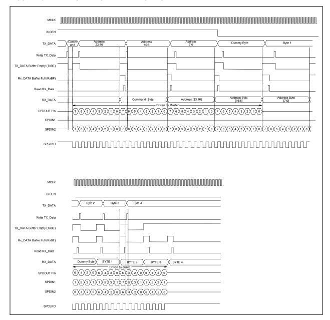
FIGURE 20-4: DUAL FAST READ FLASH COMMAND
