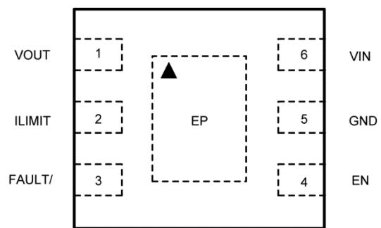
**2mm x 2mm 6-pin Thin DFN (MT)<sup>(3)</sup>
